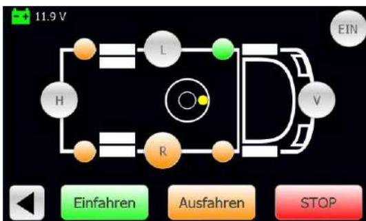
Die Stützen werden pro Paar, **links, rechts, vorne** und **hinten gesteuert**. Wählen Sie die zu steuernde Seite aus, durch auf den Buchstaben zu drücken. Die Buchstabe leuchtet auf und verwenden Sie die Tasten **[Einfahren]** und **[Ausfahren]**, um die Stützen zu steuern.
